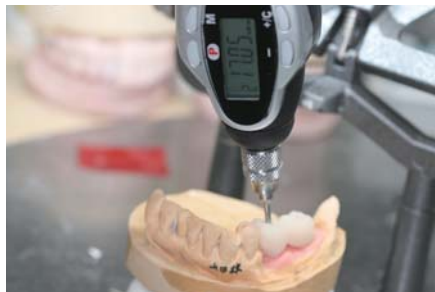
フィットが重要なスクリュー固定の トルク管理の標準化に
